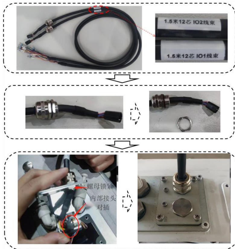
图 3-20 IO 锁头安装示意图
