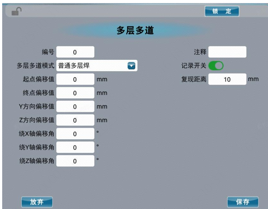
图 3-73 多层多道记录开关
