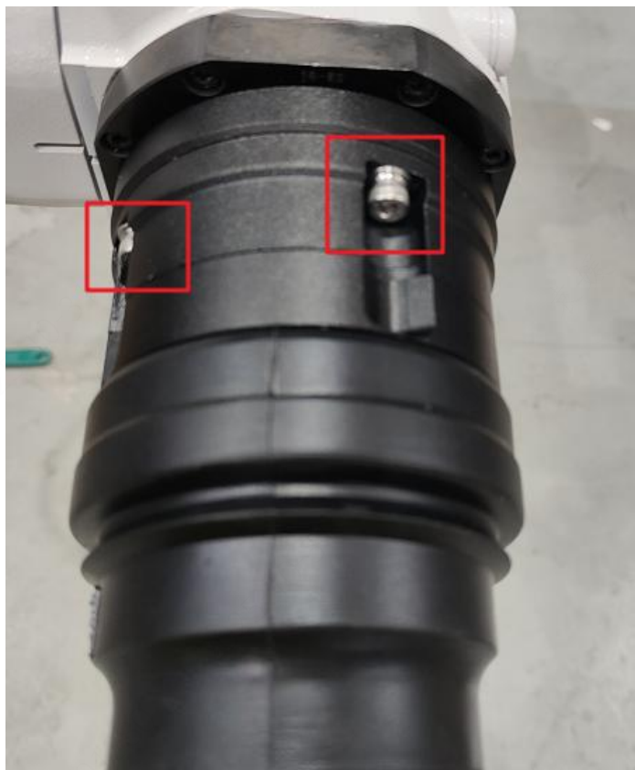
图 2-18 螺钉连接焊枪与法兰
