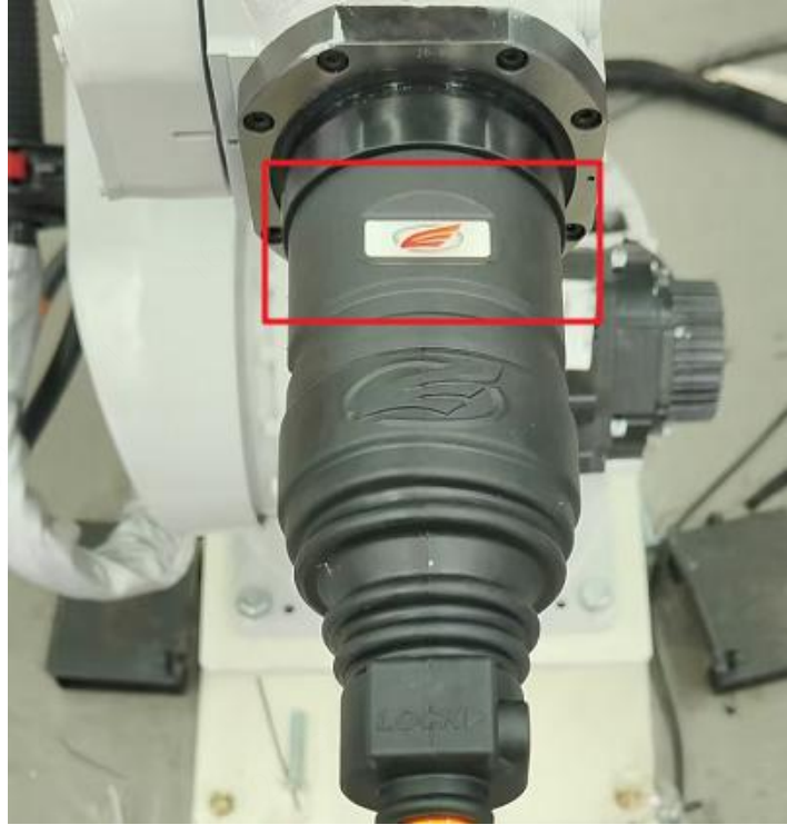
图 2-12 焊枪保护罩安装位置
