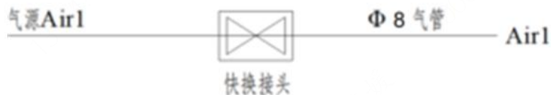
图 3-13 焊接气路原理图 (标准)
