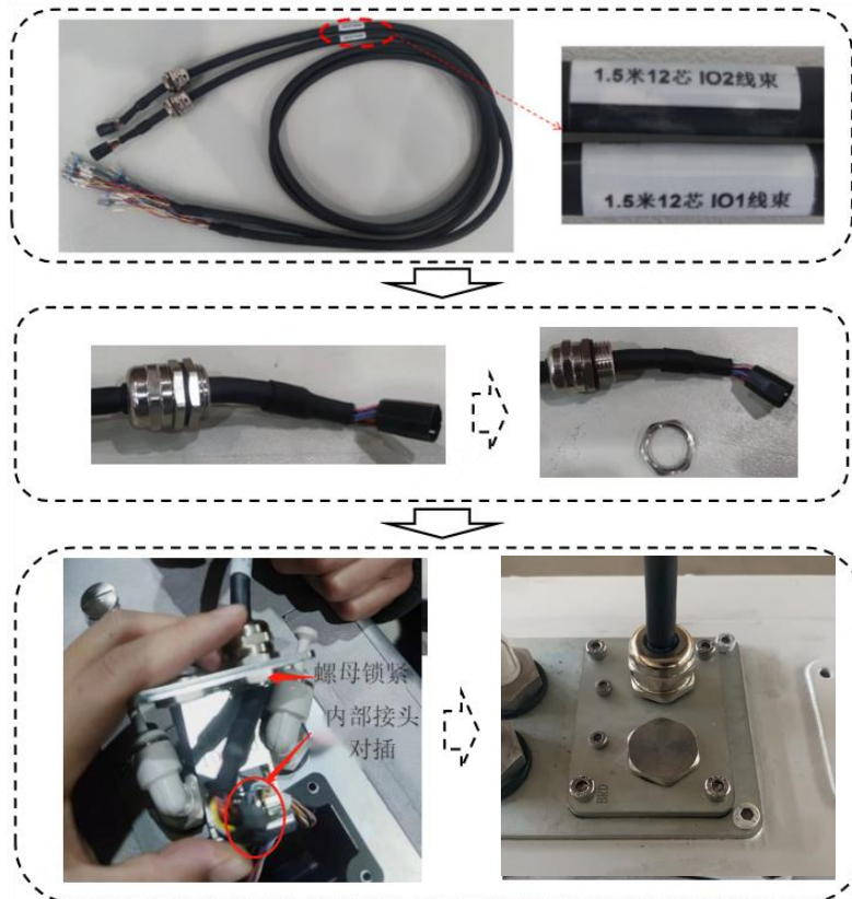
图 3-18 IO 锁头安装示意图
