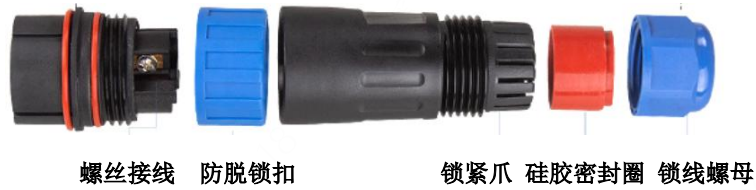
图 4.2.2 连接器拆解图
