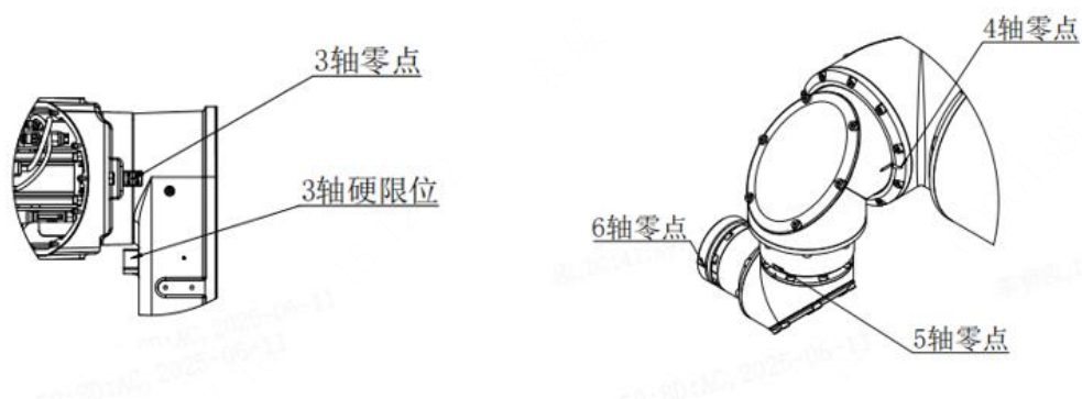
图 2-4 机械硬限位位置及零标位置
