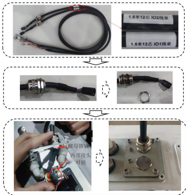
图 3-18 IO 锁头安装示意图
