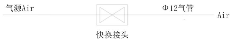
图 3-20 标准型气路原理图（标准）
