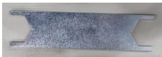
a. 小臂 I0 信号线安装扳手
