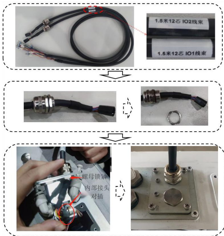
图 3-19 IO 锁头安装示意图
