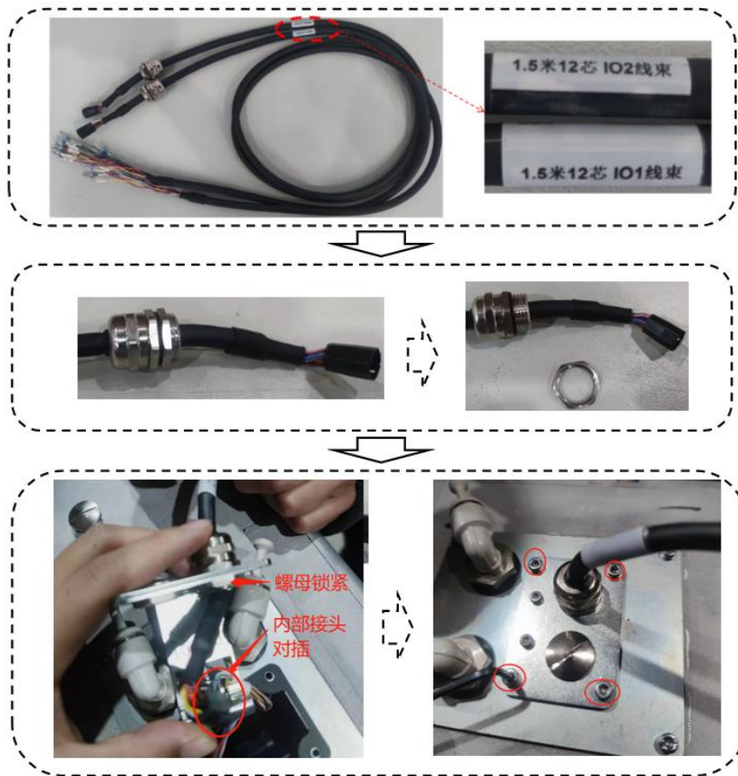
图 3-15 I0 接头安装示意图
