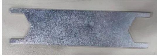
a. 小臂 I0 信号线安装扳手
