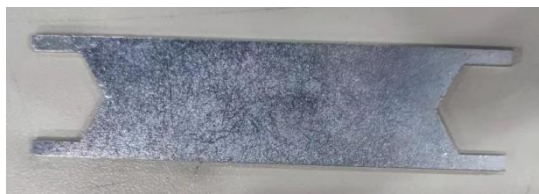
a. 小臂 I0 信号线安装扳手
