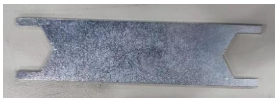
a. 小臂 I0 信号线安装扳手
