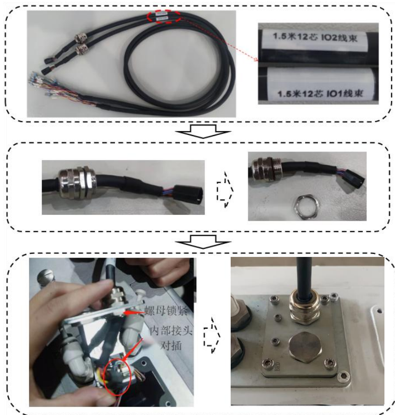
图 3-15 IO 锁头安装示意图
