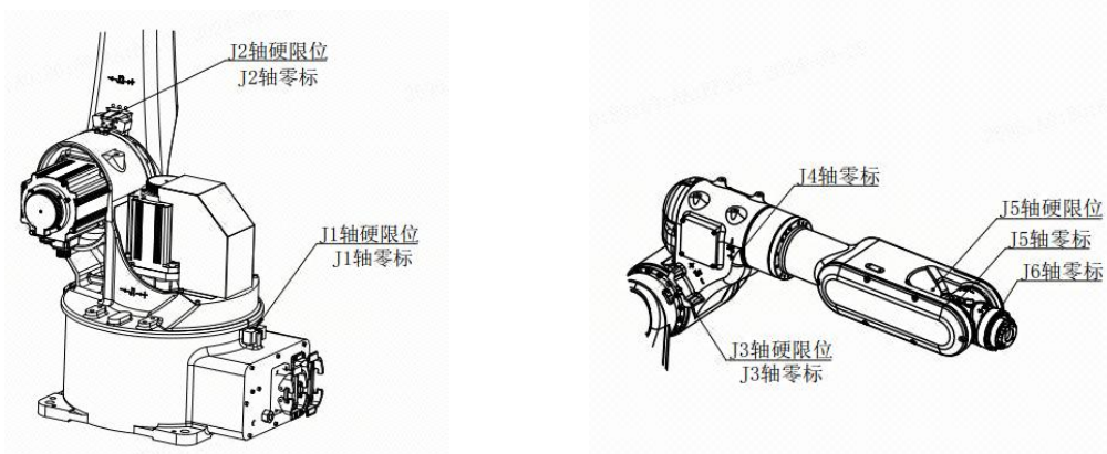
图 2-4 机械硬限位位置及零标位置
