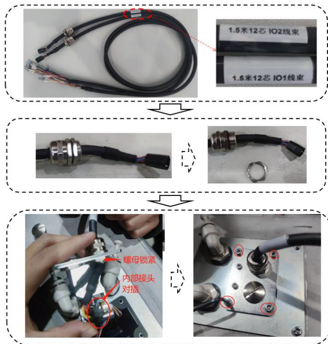
图 3-15 IO 锁头安装示意图
