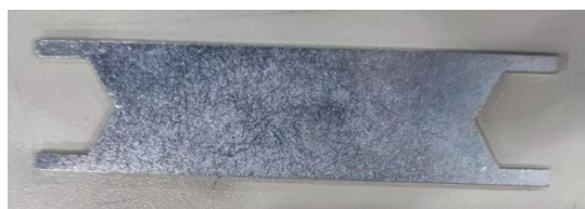
a. 小臂 IO 信号线安装扳手
