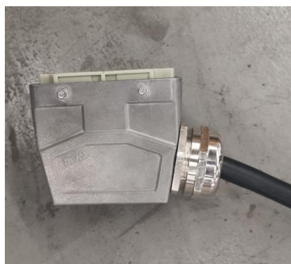
电机电源线缆接头
