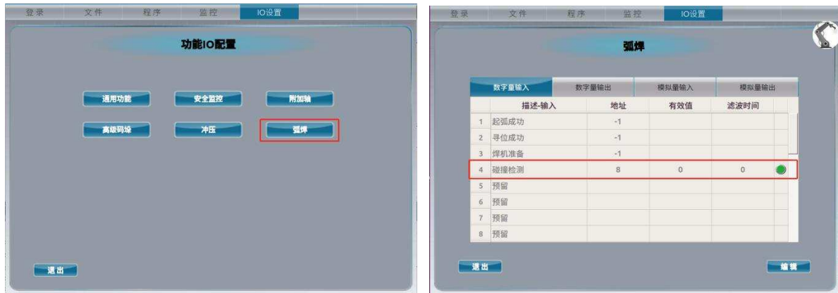
图 2-21 防碰撞信号配置(示教器界面)
