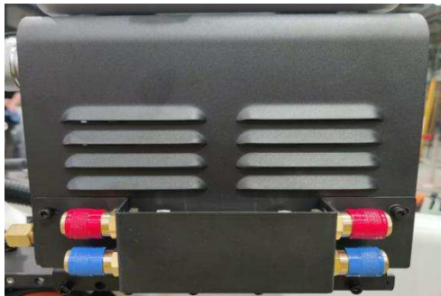
图 2-5 水冷组件安装位置
