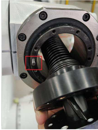
图 2-10 定位销安装位置
