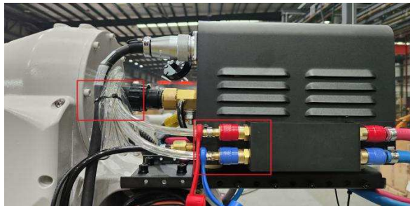
图 2-20 水冷焊枪走线
