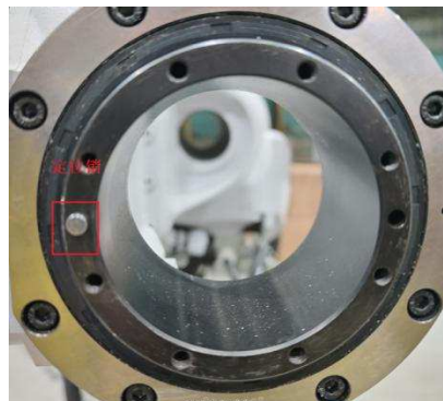
图 2-17 定位销安装位置
