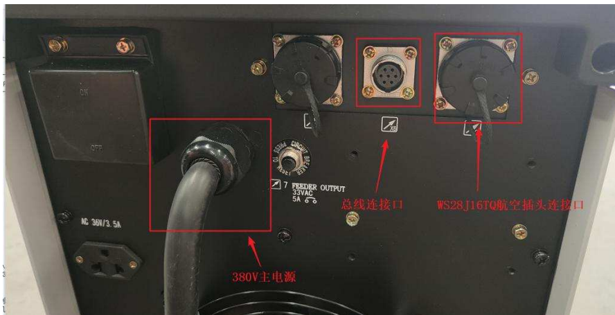
图 2-22 焊接电源接口
