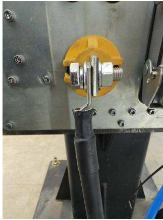
图 2-4 焊机正极线固定处
