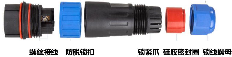
图 4.2.2 连接器拆解图
