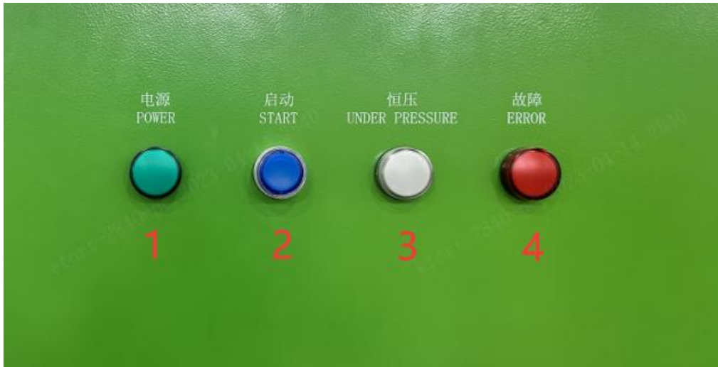
图 2-3 防爆电柜的外部布局
