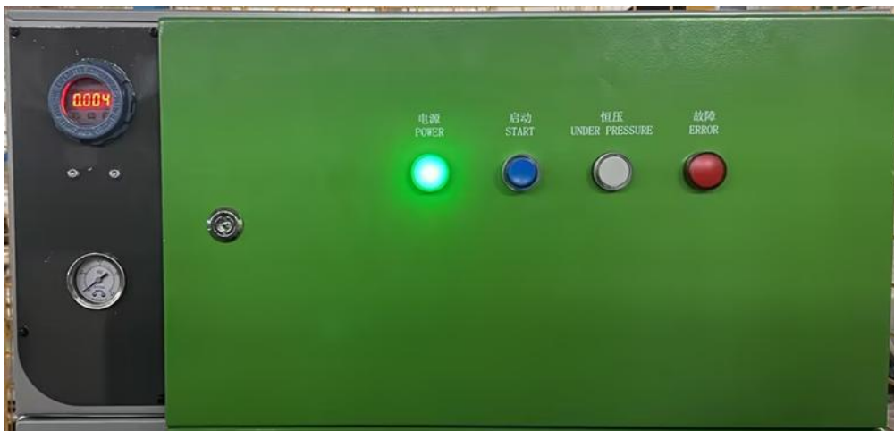
图 2-2 防爆电柜的外部结构
