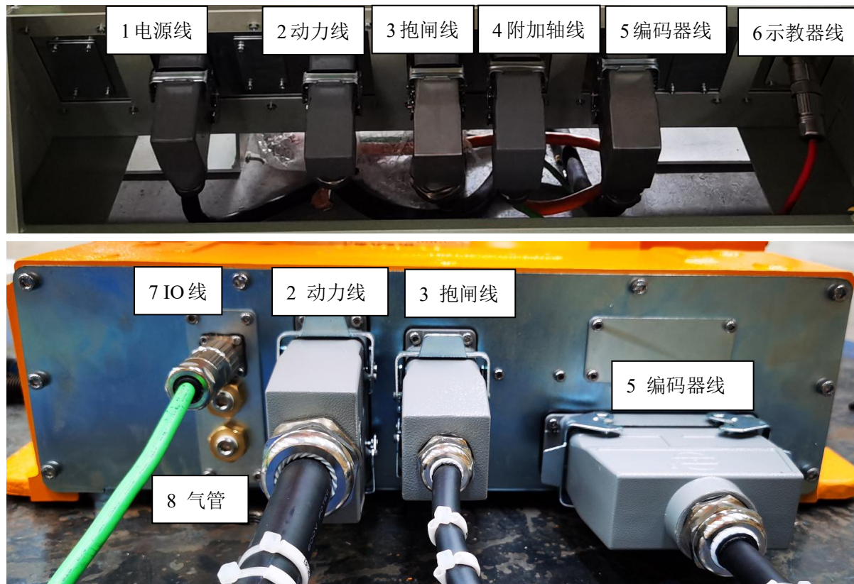
图 3-5 控制柜与本体连接示意图
