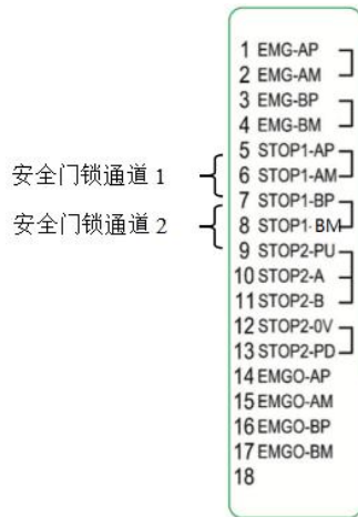
图 3-17 X13 安全门锁接线图
