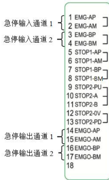
图 3-15 X13 急停功能接线图
