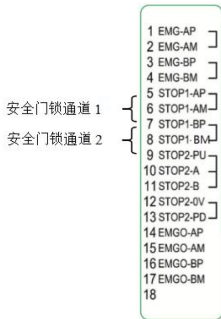
图 2-10 X13 安全门锁接线图
