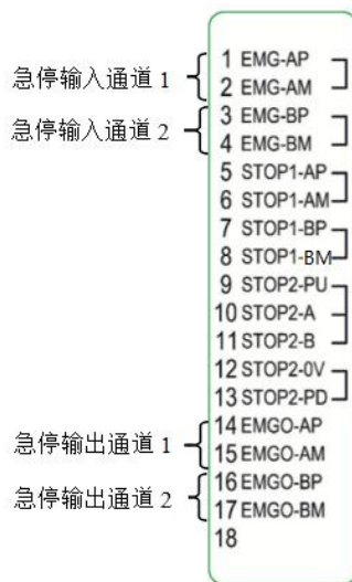
图 2-8 X13 急停功能接线图
