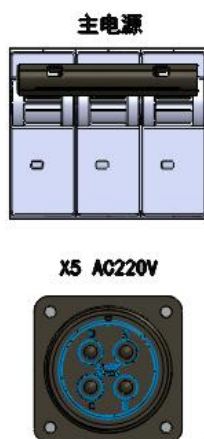
图3-21 电柜前面板电源示意图
