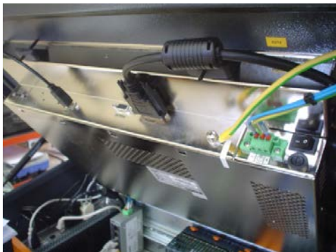
Figure30: Replacing the Display 更换显示器
