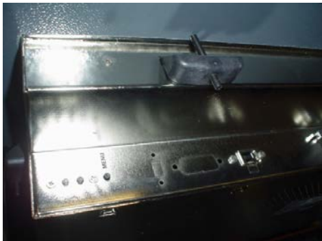
Figure3101: Replacing the Display 更换显示器
