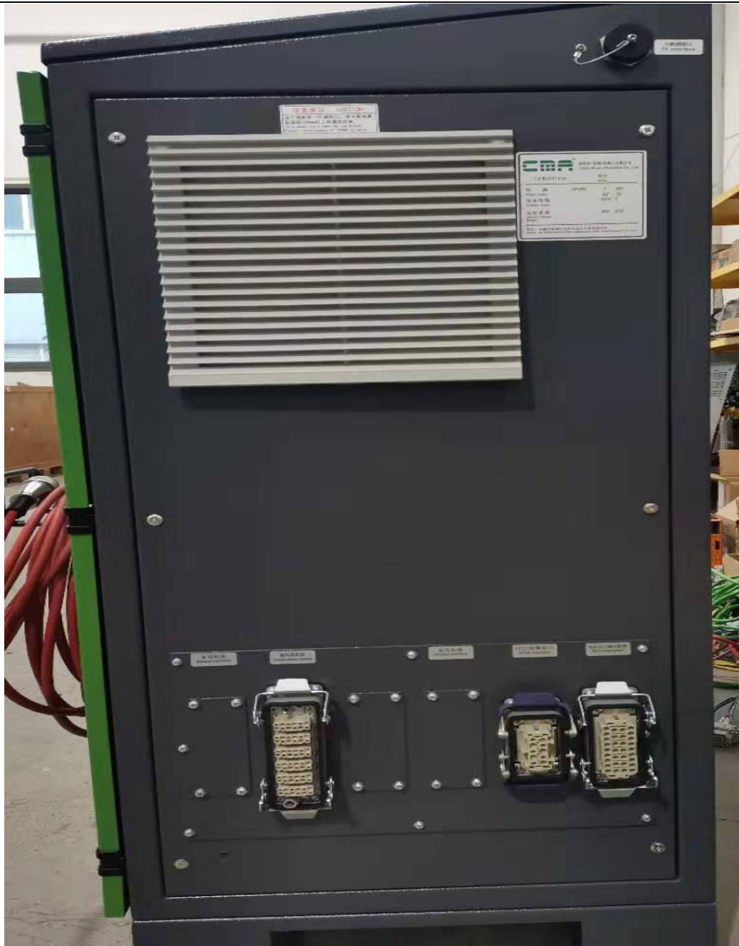
电柜右侧面相关元器件布局与安装
