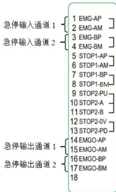
图 3-15 X13 急停功能接线图
